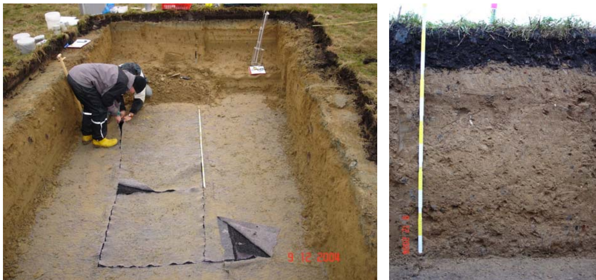
Bild 1 Rekultivierungsschicht und Dränmatte in Schurf 5 (links) und 4 (rechts)
