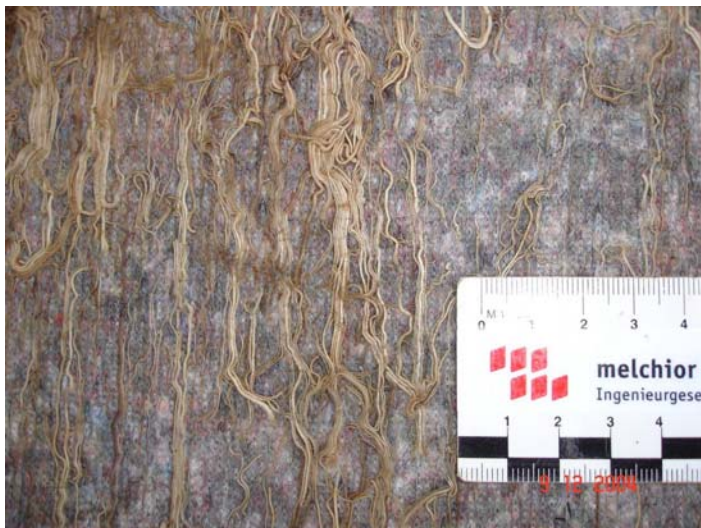
Bild 3 Wurzelgeflecht an der Unterseite der Dränmatte in Schurf 4
