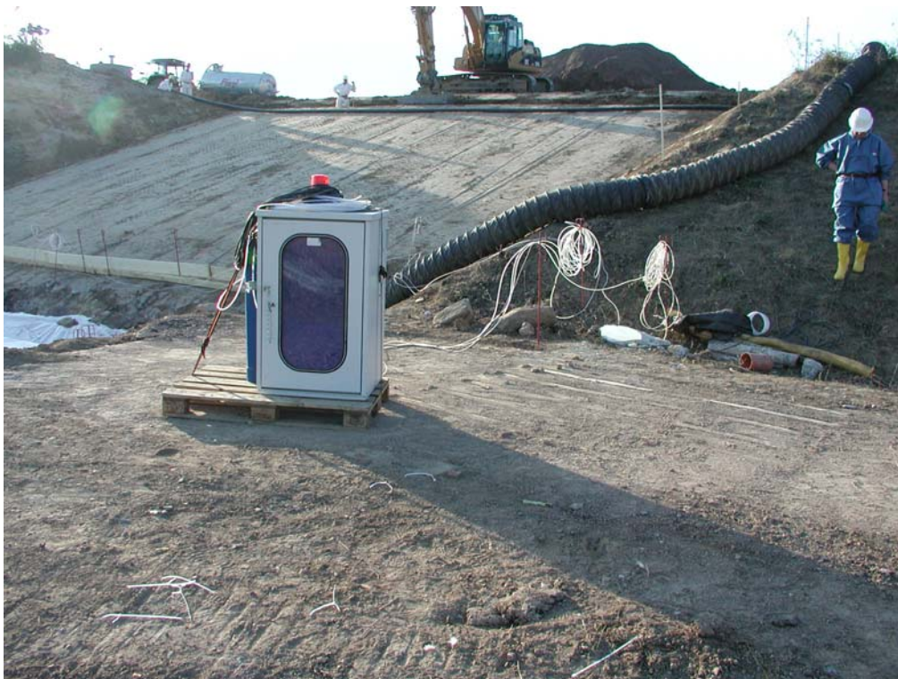
Foto 6 Gaschromatographen zum Messen der Gaszusammensetzung mit Gasmesssonden und Bewetterungsanlage im Hintergrund
